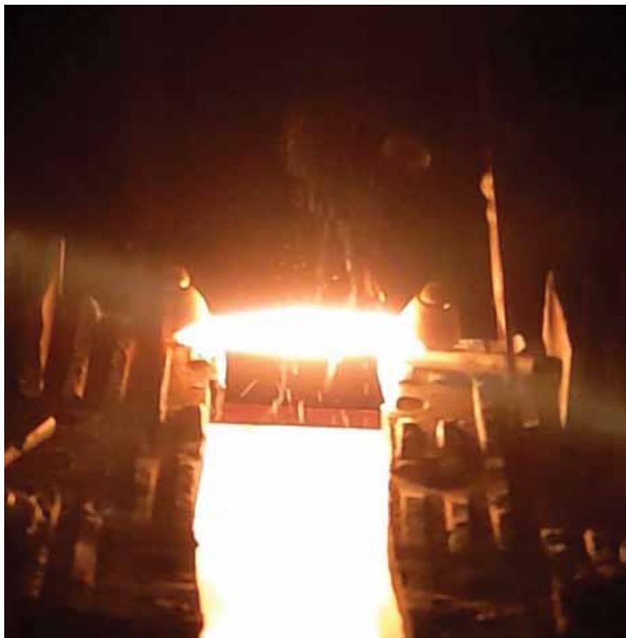
**Рис. 3.****Возгонка металла с графитовой подложки.**
