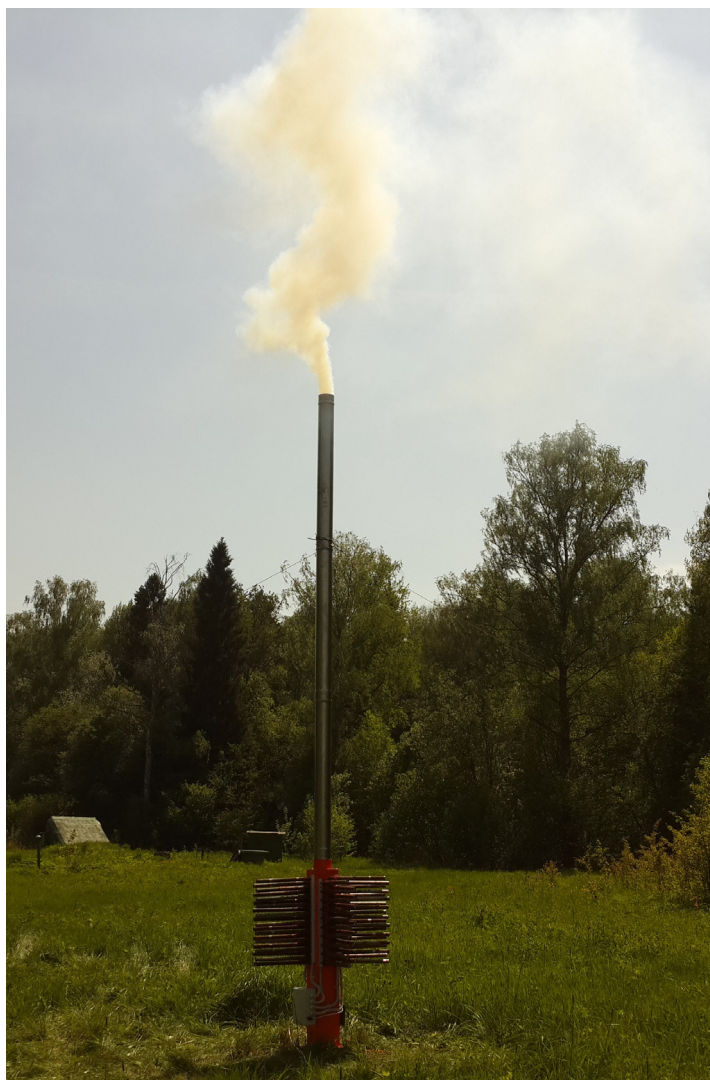
Рис. 1. Общий вид наземного аэрозольного генератора НАГ-07М с установленными активными элементами «АГ-1М».
