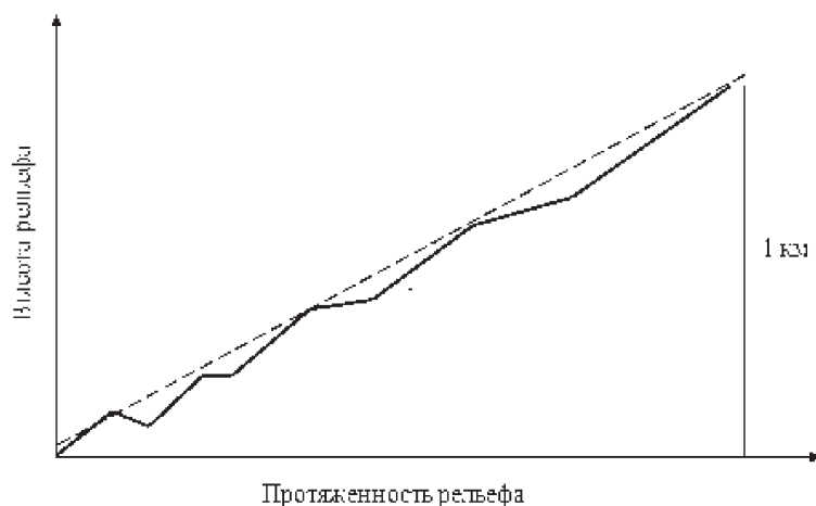
Рис. 2. Схема определения программой Map Info среднего наклона рельефа местности.
